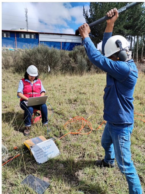
Fotografía 6.- Trabajos de campo sondeo geofísico SG-2 (sismico)
