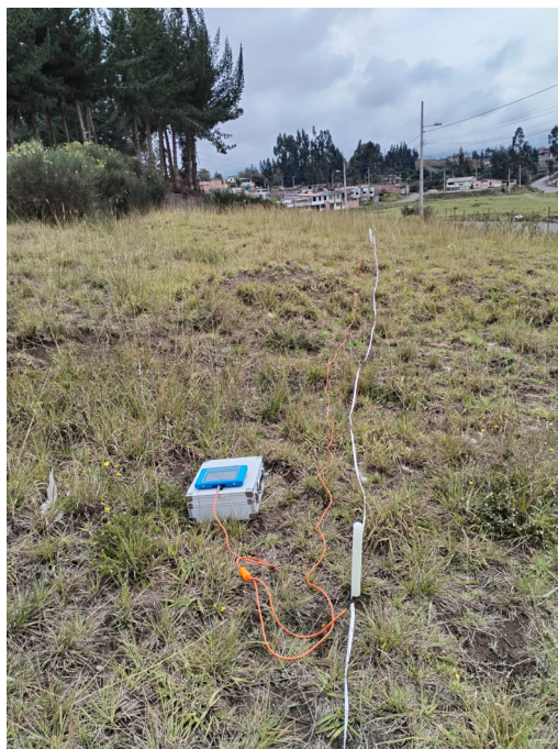
Fotografía 5.- Trabajos de campo sondeo geofísico SG-1 (eléctrico)
