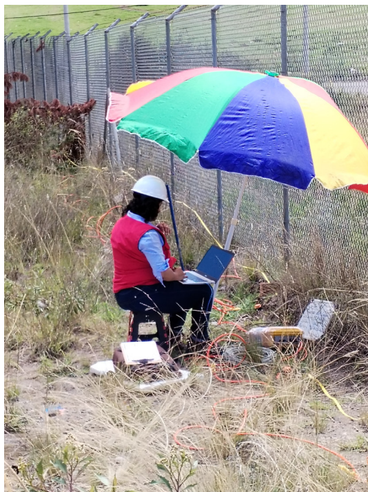
Fotografía 7.- Trabajos de campo sondeo geofísico SG-3 (sismico)
