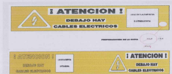
Figura 15.- Cinta de señalización ductos
