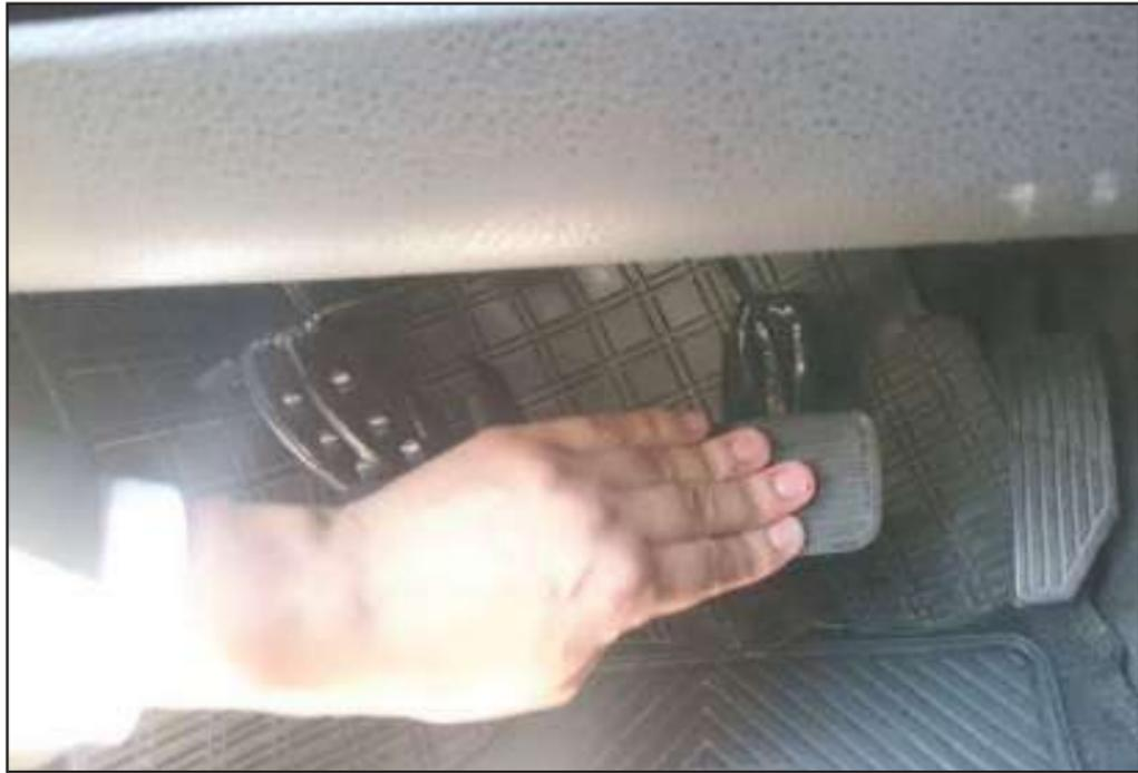
El candado se coloca en los pedales de embrague y freno de los automotores.
